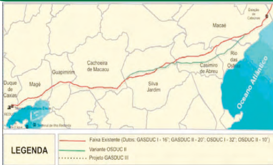
Gasoduto GASDUC III
