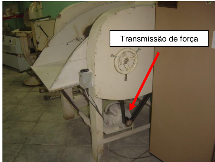
Figura 23 - Transmissão de força exposta em cilindro de panificação
