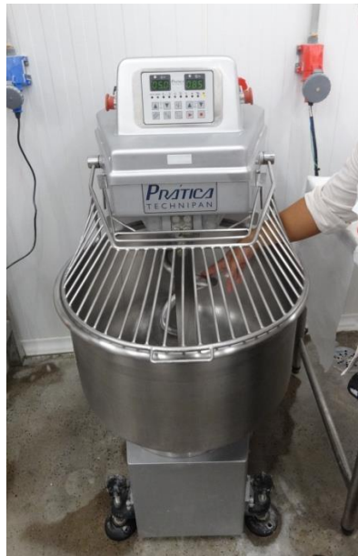
Figura 71 – Amassadeira com acesso à zona de perigo
