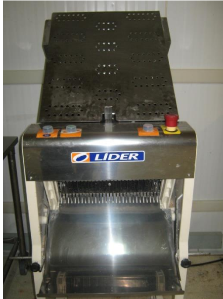
Figura 92 - Fatiadora de pães com proteção fechada
