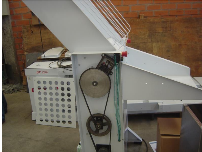
Figura 21 - Transmissão de força em cilindro de panificação
