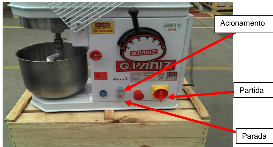
Figura 56 - Batedeira com dispositivo de acionamento (verde), parada (vermelho) e dispositivo de partida (vermelho com fundo amarelo).
