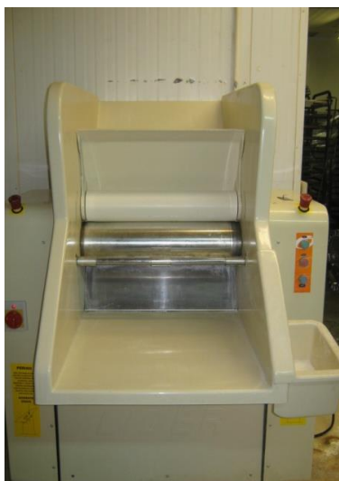
Figura 13 - Proteção móvel intertravada aberta - cilindro de panificação
