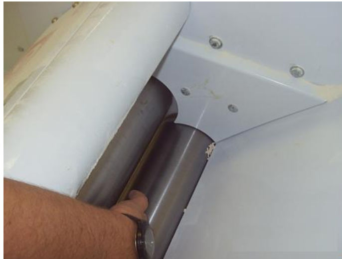
Figura 2 - Risco de aprisionamento e/ou esmagamento das mãos em cilindro de panificação
