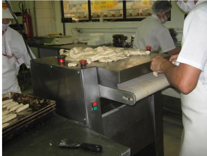
Figura 11 - Modeladora com proteção móvel intertravada.
