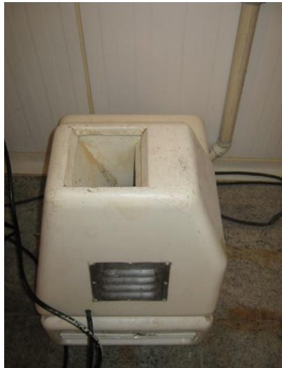
Figura 25 - Moinho sem proteção
