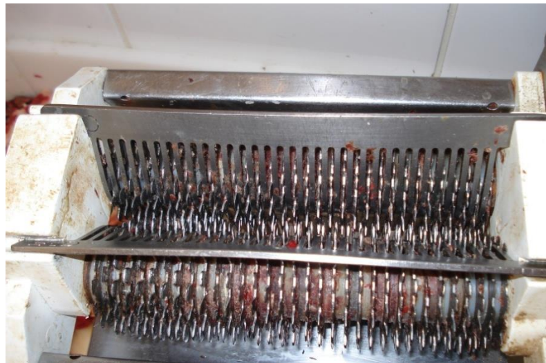
Figura 101 – Cilindros dentados no amaciador de bifes
