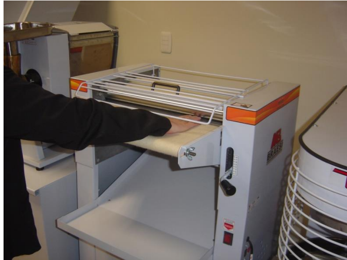
Figura 14 - Proteção em modeladora que não impede o acesso à zona de perigo da máquina.
