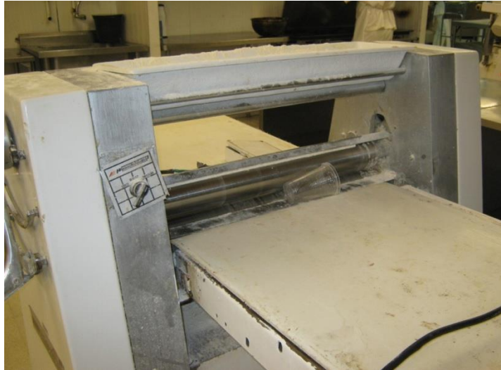
Figura 85 - Laminadora sem proteção
