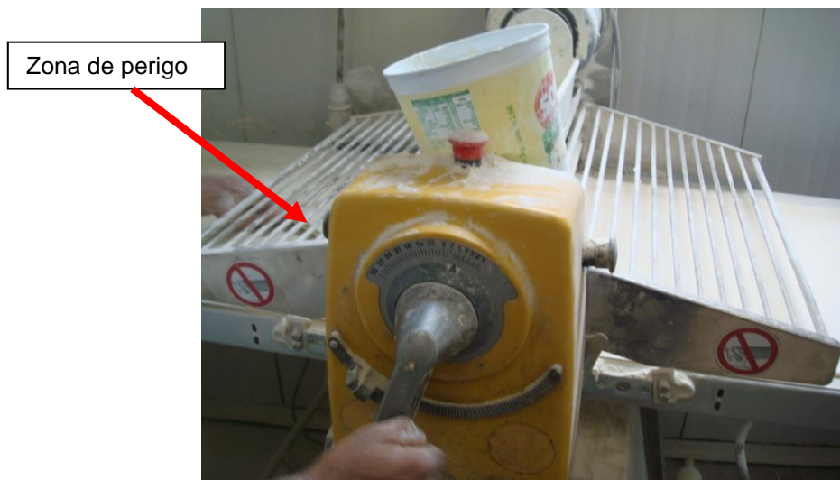
Figura 86 - Laminadora com proteção inadequada
