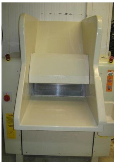
Figura 12 - Proteção móvel intertravada fechada - cilindro de panificação
