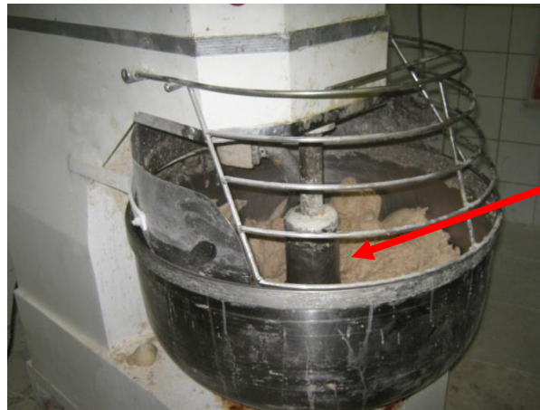
Figura 70 – Amassadeira com proteção inadequada
