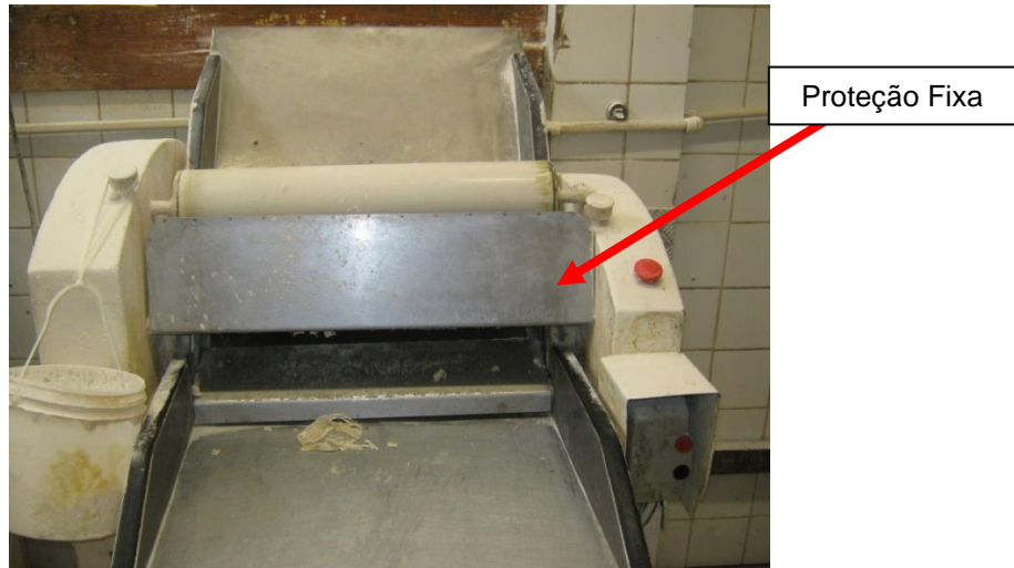
Figura 79 – Cilindro com proteção fixa inadequada
