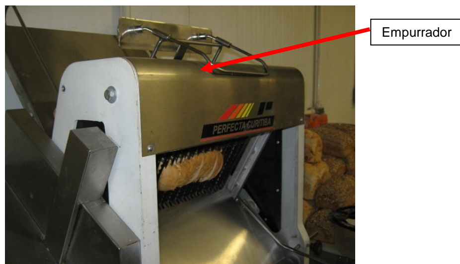
Figura 89 - Fatiadora de pães com dispositivo empurrador
