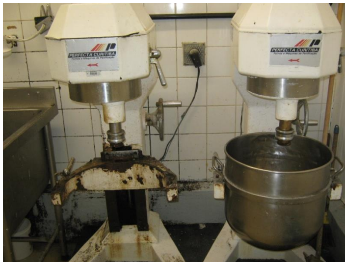
Figura 74 – Batedeiras sem proteção –
