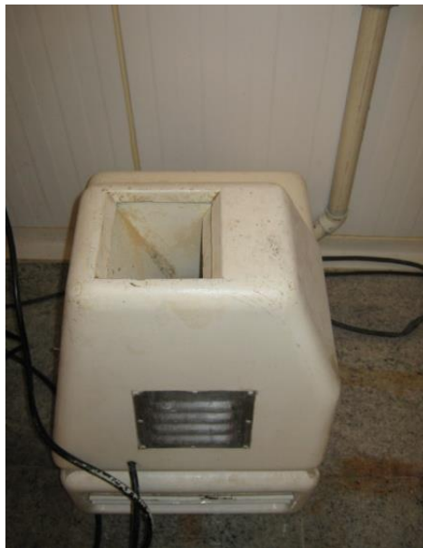
Figura 94 - Moinho sem proteção
