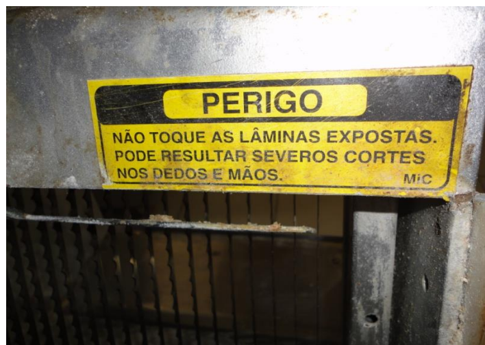
Figura 53 – Sinalização de segurança em fatiador de pães
