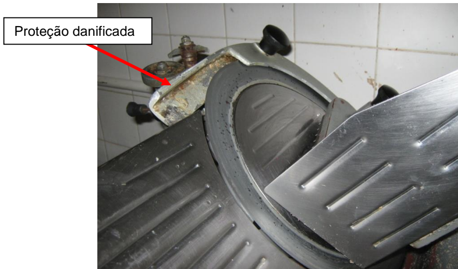
Figura 105 - Fatiador de frios com proteção danificada
