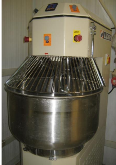
Figura 61 - Amassadeira com dois botões de parada de emergência
