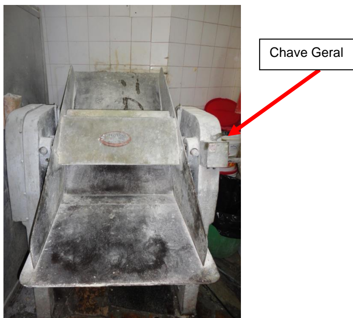
Figura 45 - Chave geral como dispositivo de partida de máquina
