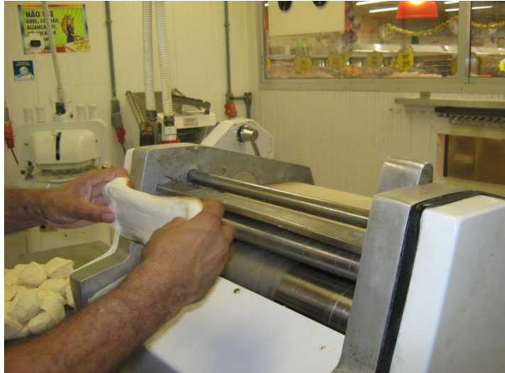
Figura 82 - Modeladora sem proteção
