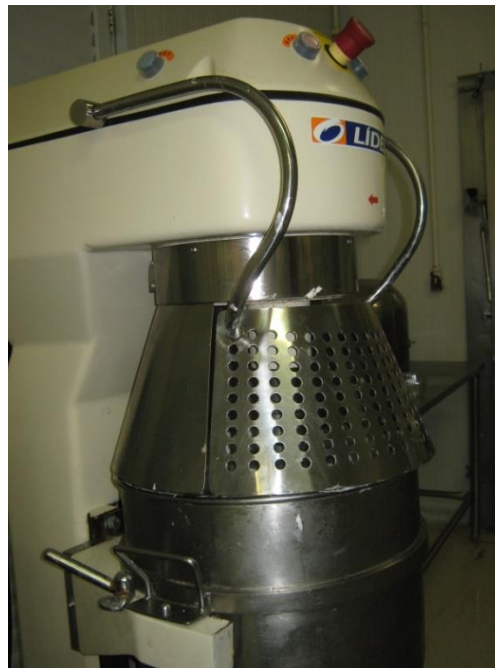
Figura 47 - Proteção da bateadeira em aço inox - inviabilidade técnica de utilização de cor
