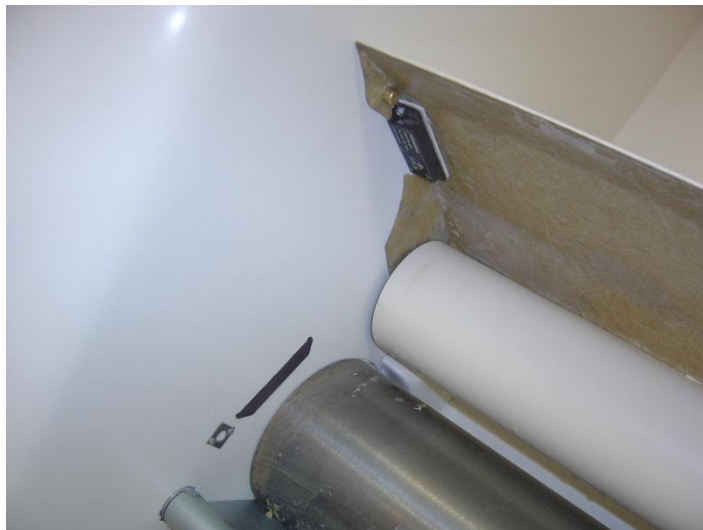
Figura 36 - Chave de segurança magnética em cilindro de massa
