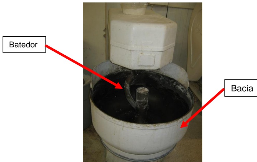
Figura 69 – Amassadeira sem proteção
