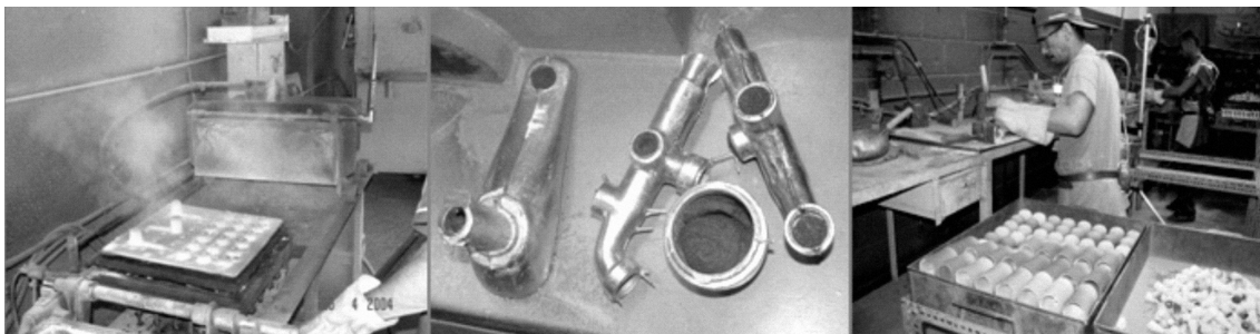
Figura 24 Processo shell molding Fonte: Peixe e Nascimento (2008)
