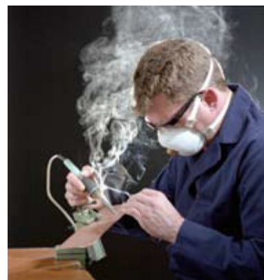
Figura 15 Operação de solda com e sem o uso da iluminação Tyndall Fonte: Health and Safety Executive (2011)
