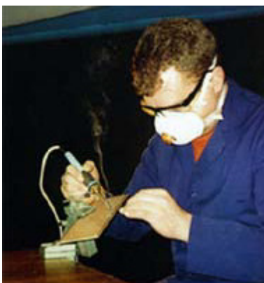
Figura 15 Operação de solda com e sem o uso da iluminação Tyndall Fonte: Health and Safety Executive (2011)
